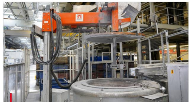
SMARTT Prozesssteuerung für die Rotorentgasung von Aluminiumschmelze
